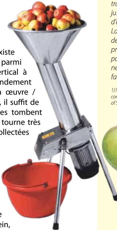
En éclatant les pommes le broyeur permet un pressurage efficace.
